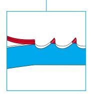
C'est une lame de scie à ruban en bi-métal: la denture en Super HSS au cobalt (M42) est soudée par un procédé électronique sur un corps de lame en acier de ressort.
